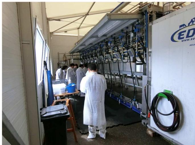
昇降機つきタンデムパーラー 牛を導入後、牛が乗る床を昇降させることで人がしゃがまずに搾乳作業ができる 人の作業場所を掘り下げて作る必要がないため、建設費のコスト削減や既存施設などにも導入が可能
