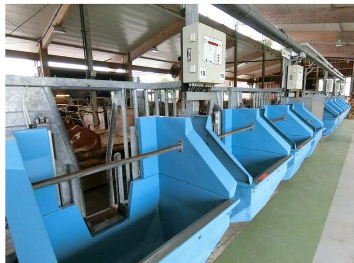
給与試験を実施するための機器 給与時重量から採食した分をマイナスし採食量を計測 牛の首に取り付けてあるセンサーで個体を識別する
